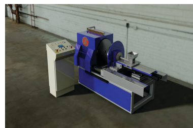
SÉRIE MÁQUINA GML Para revestimento de metal branco/ Babbitt Sistema de trava dupla
